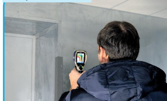
Тепловизор фиксирует температуру заперенных участков. Холод поступает беспрепятственно.
